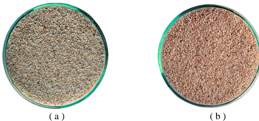
Slika 2.1. Usporedba prirodnog (a) i Fe(III)-modificiranog zeolita (b).
