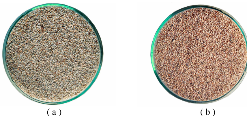
Slika 2.1. Usporedba prirodnog (a) i Fe(III)-modificiranog zeolita (b).
