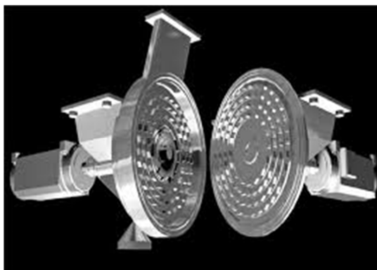
Slika 1.9. Uređaj za tribomehaničku modifikaciju. 27
