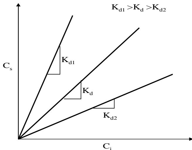
Slika 1.9. Grafički prikaz adsorpcijske izoterme i koeficijenta raspodjele<sup>19</sup>.
