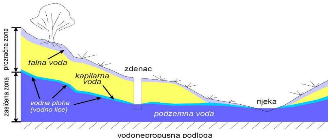
Slika 1.6. Shematski prikaz načina pojavljivanja vode u podzemlju<sup>7</sup>.
