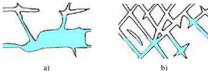
Slika 1.5. Poroznost kraškog vodonosnika: a) pukotinsko-disolucijska poroznost; b) pukotinska poroznost<sup>8,9</sup>.
