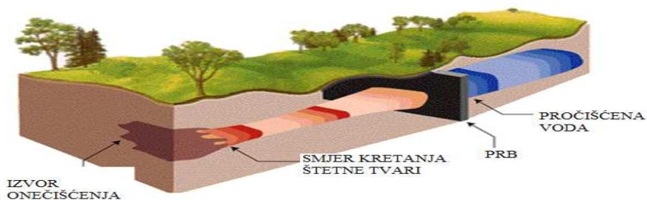
Slika 1.10. Slikoviti prikaz metode *in situ* remedijacije primjenom permeabilne reaktivne barijere (PRB)<sup>21</sup>.
