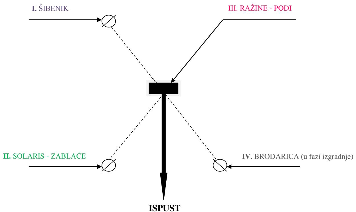
Slika 1.5. Funkcionalna shema kanalizacijskog sustava<sup>5</sup>.
