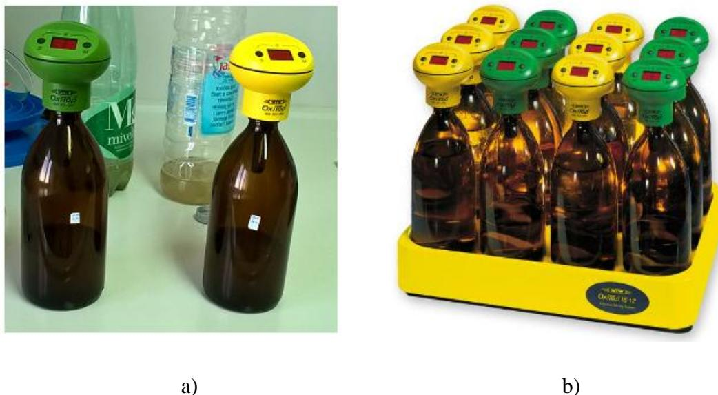
Slika 2.10. a) Boce s Oxi Topom, b) instrumentalni set za određivanje BPK<sub>5</sub> manometarskom metodom<sup>15</sup>.
