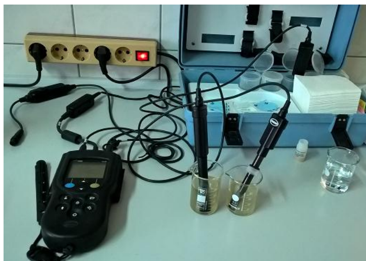
Slika 2.2. Prijenosni mjerni uređaj HQ40d.
