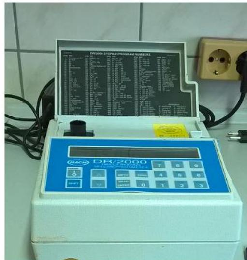
Slika 2.9. Spektrofotometar.
