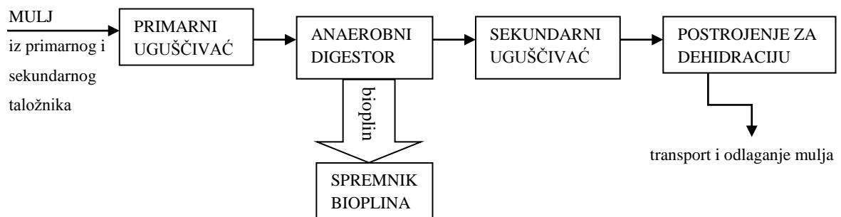
Slika 1.24. Shema obrade mulja anaerobnom digestijom.
