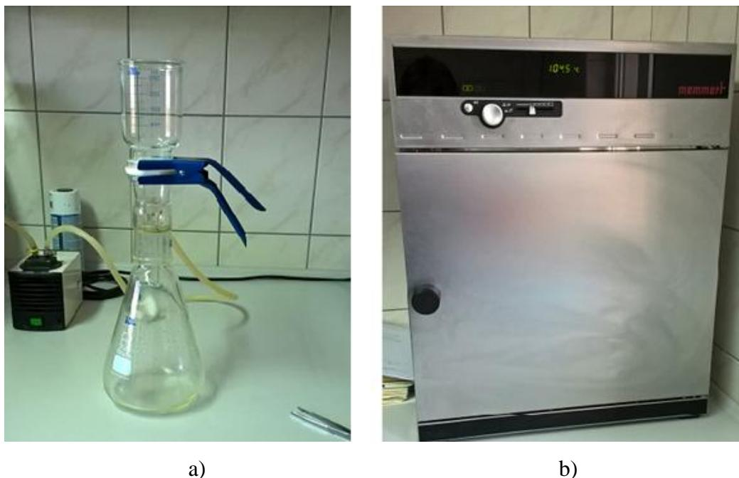
Slika 2.5. a) Uređaj za filtraciju, b) sušionik.
