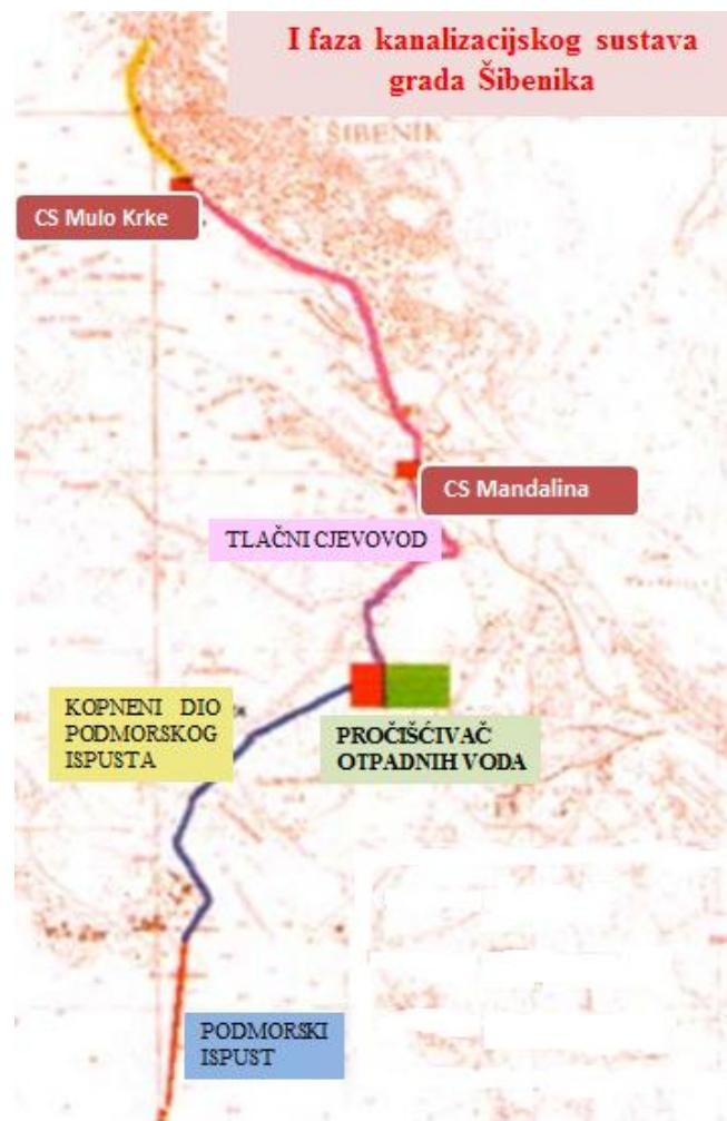
Slika 1.4. Shema kanalizacijskog sustava Šibenika<sup>12</sup>.
