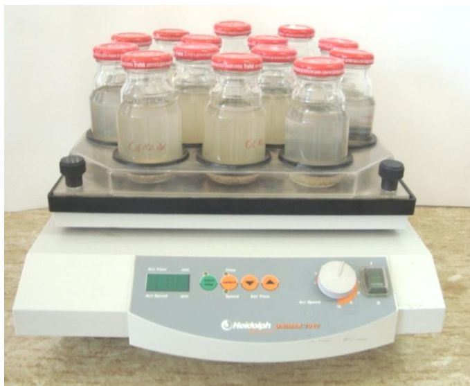
Slika 2.3. Izvedba zasićivanja sorbenata sa kadmijevim ionima šaržnim postupkom.
