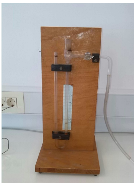
Slika 16. Blaine-ov zračni permeabilimetar
