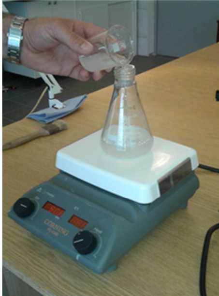
Slika 12. Miješanje komponenti i nastanak gela zeolita A
