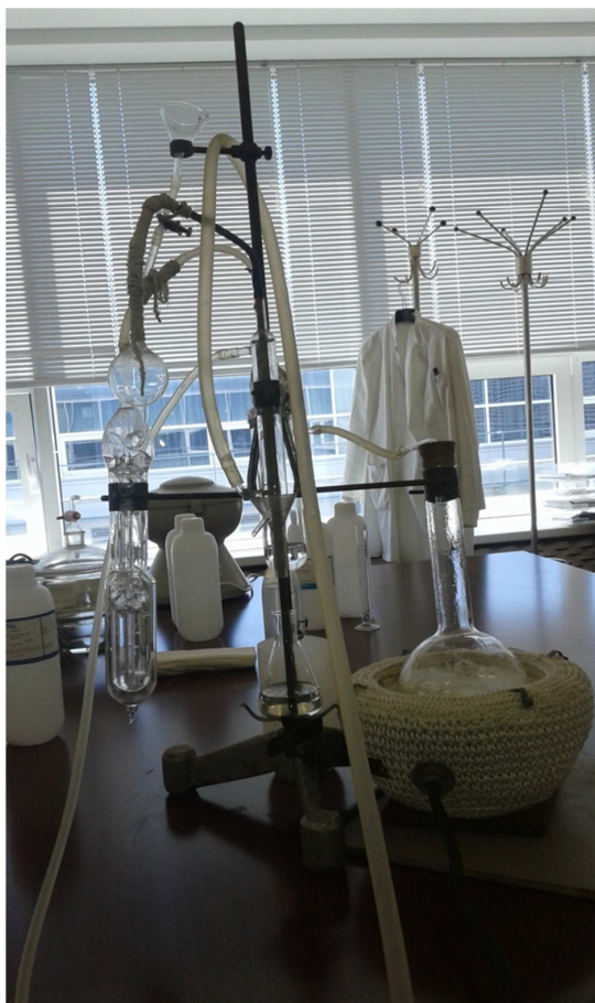
Slika 15. Aparatura za mikrodestilaciju po Kjeldahlu
