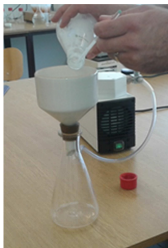
Slika 13. Ispiranje uzoraka ultračistom vodom i filtracija kroz Büchnerov lijevak
