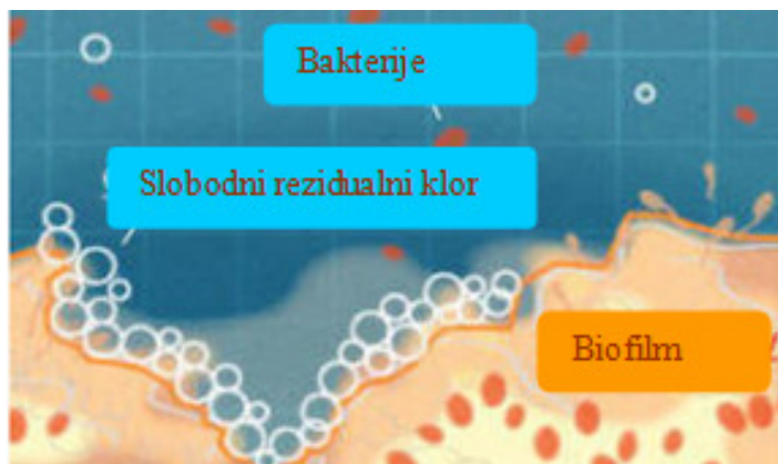
Slika 2.3. Shematski prikaz djelovanja slobodnog rezidualnog klor na biofilm 20 .
