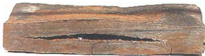
Slika 2.10. Vodikova bolest ugljičnog čelika 32 .
