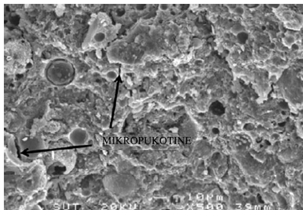
Slika 17. SEM snimka geopolimera na bazi letećeg pepela 28 dana nakon početka reakcije geopolimerizacije 39
