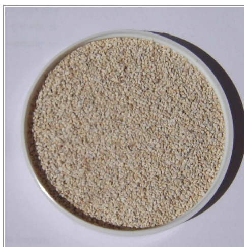
Slika 3.1. Uzorak prirodnog zeolita veličine čestica 0,6 - 0,8 mm.
