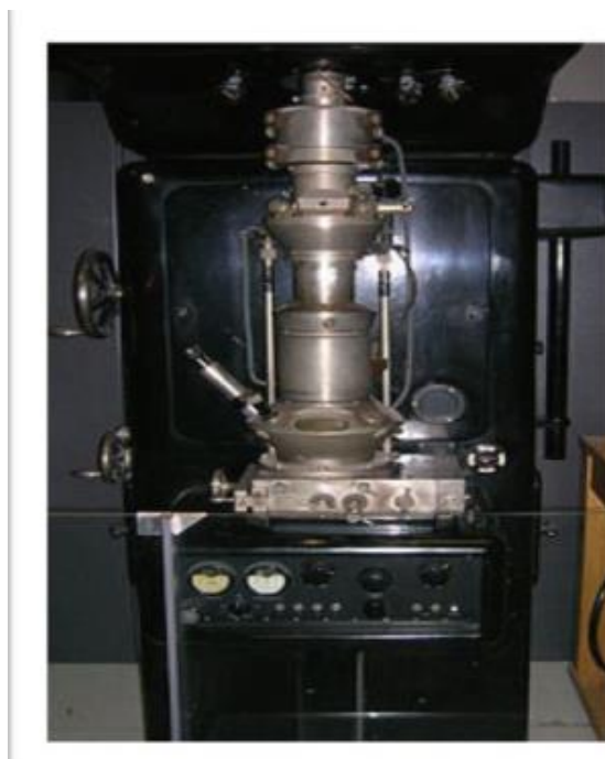
Slika 9 Prvi praktični TEM, izvorno postavljen u IG Farben-Werke, a sada izložen u Deutsches Museumu Münchenu, Njemačka.
