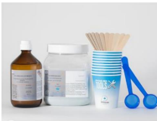
Slika 20. Akrilna smola Presi resin KM B korištena za izolaciju elektroda.
