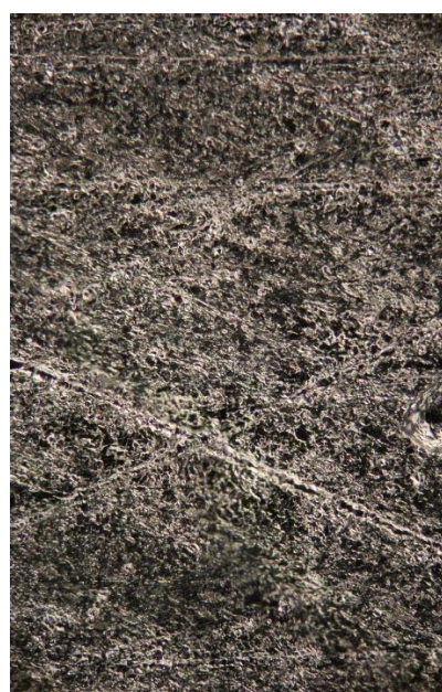
Slika 40. Površina S275 uzorka nakon PD mjerenja u gorkoj morskoj vodi pri T = 35^{\circ}\text{C} bez inhibitora (a) i uz inhibitor (b).
