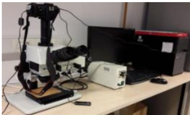
Slika 18. Ispitivanje površine elektroda svjetlosnim mikroskopom MXFMS-BD, Ningbo Sunny Instruments co. s pripadajućim digitalnim fotoaparatom Canon EOS 1300 D.
