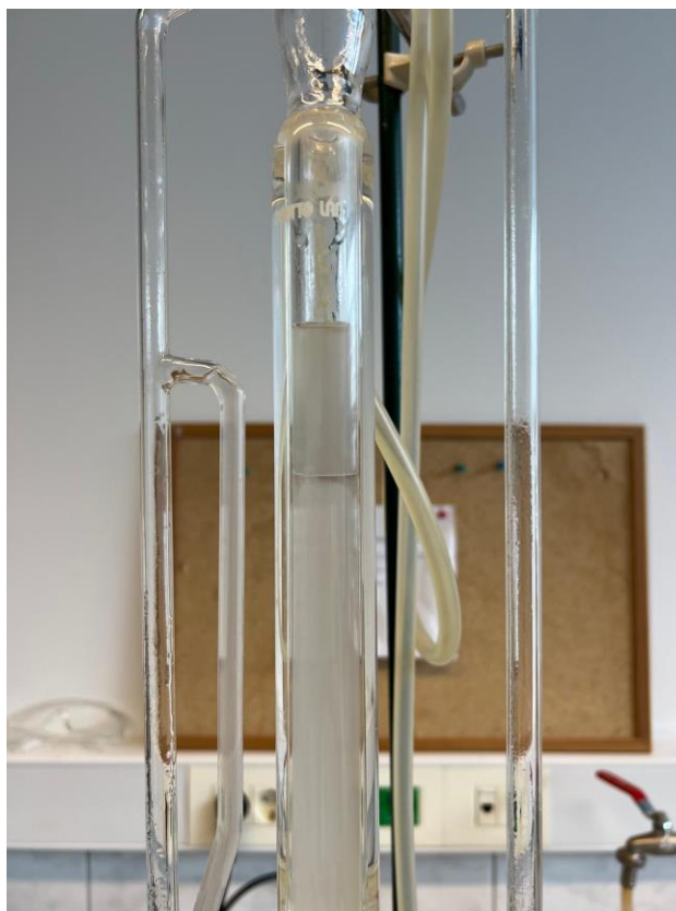
Slika 9. Prikupljanje eteričnog ulja motra u „trapu“, iznad vodenog stupca
