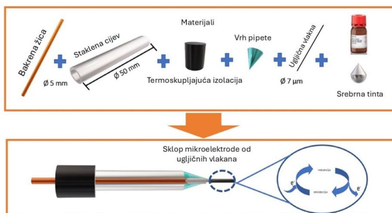
Slika 9. Proces razvoja mikroelektrode od ugljičnih vlakana [15]
