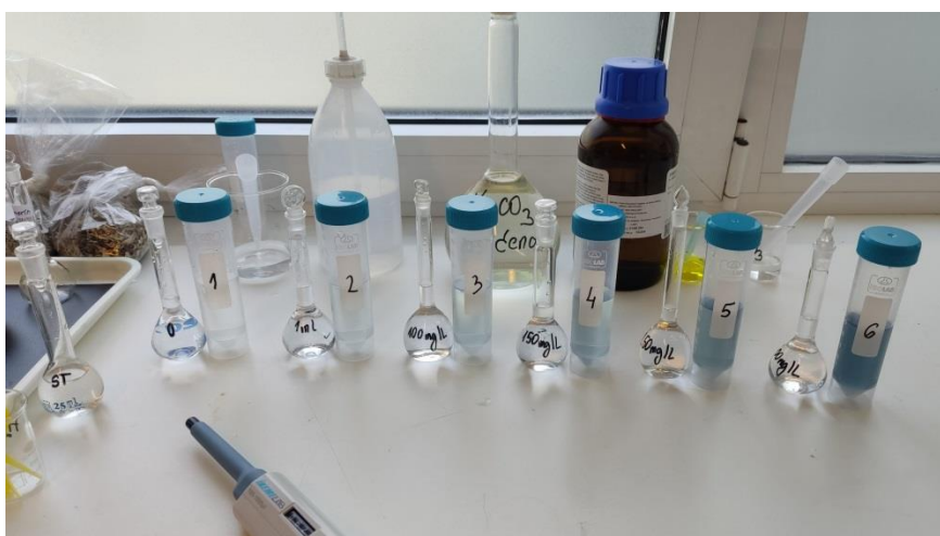
Slika 30. Standardne otopine galne kiseline za izradu krivulje umjeravanja.
