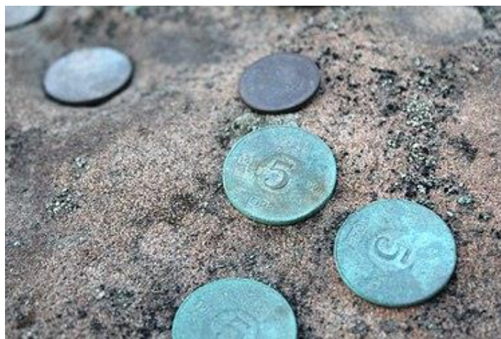
Slika 5. Pojava verdigrisa na kovanicama od bakra. 10
