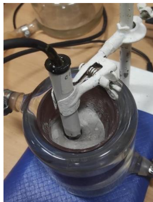
Slika 19. Elektroda za mjerenje specifične električne provodnosti uronjena u uzorak cementne paste
