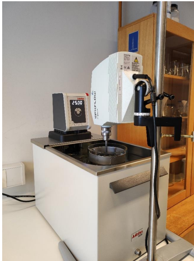
Slika 12. Aparatura za provedbu sorpcije bakrovih kationa na zeolitu NaX
