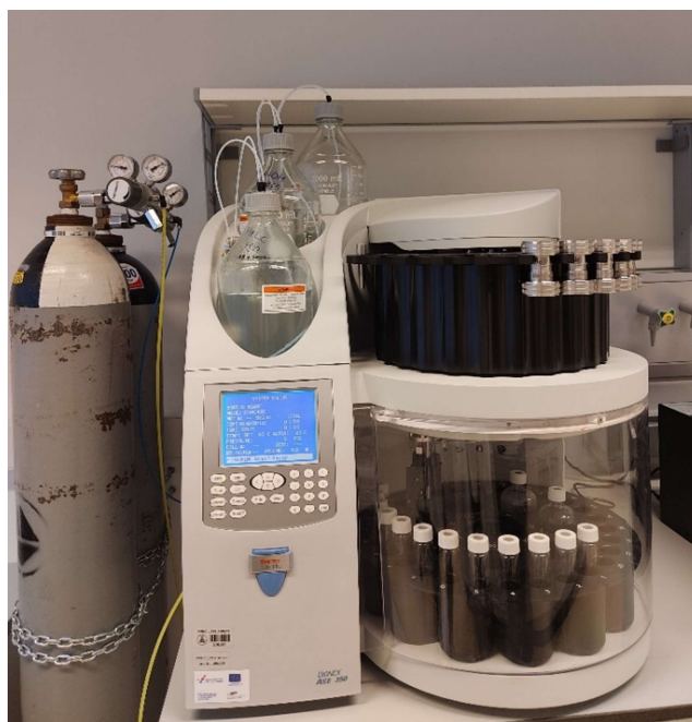
Slika 6. Uređaj za ekstrakciju potpomognutu otapalom, ASE (vlastita fotografija)
