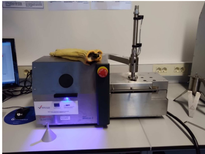
Slika 20. Prikaz ekstrudera HAAKE MiniLab 3 (Thermo Scientific, SAD)
