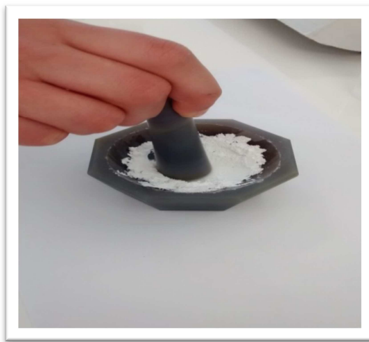
Slika 7. Priprema TiO 2 paste u tarioniku
