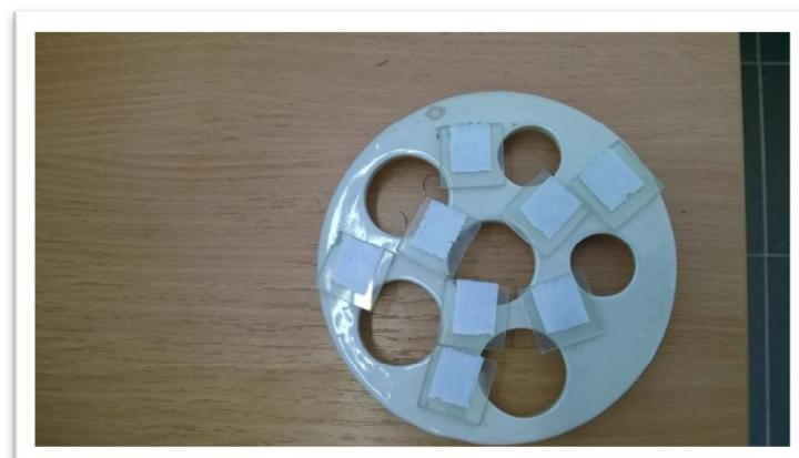
**Slika 11.** Fiksiranje TiO<sub>2</sub> paste zagrijavanjem pri
