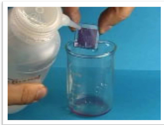
Slika 13. Ispiranje stakalca etanolom
