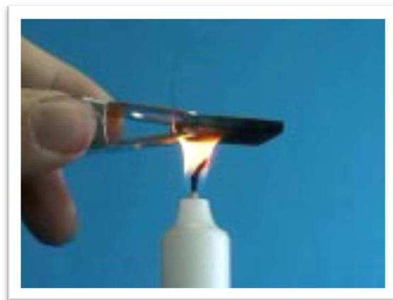
**Slika 14.** Nanošenje ugljičnog sloja
