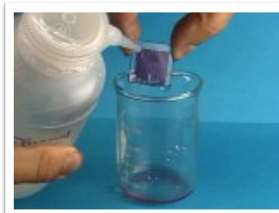
**Slika 13.** Ispiranje stakalca etanolom
