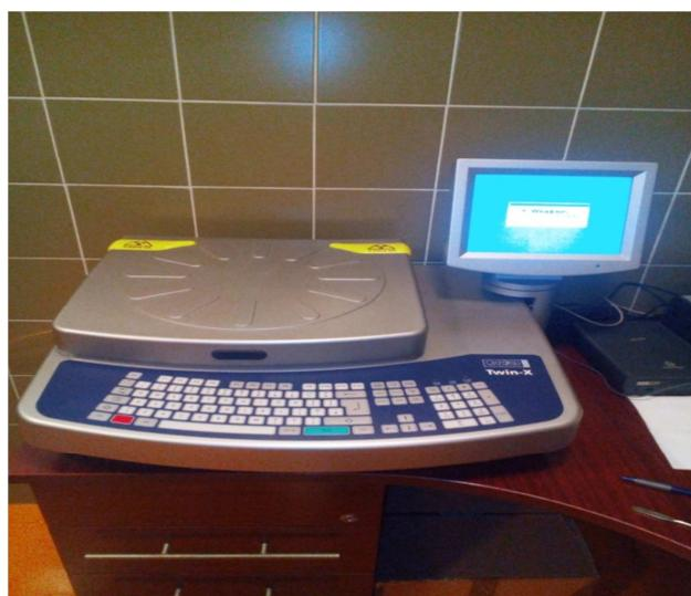
**Slika 6.** EDXRF uređaj za kvantitativnu analizu.
