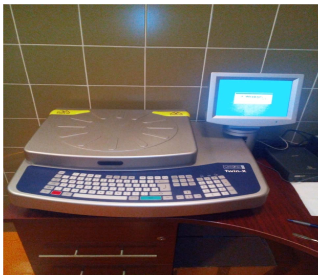
Slika 6. EDXRF uređaj za kvantitativnu analizu.
