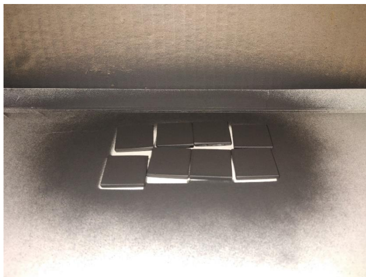
Slika 28. Stakalca s tek nanesenim grafitnim slojem
