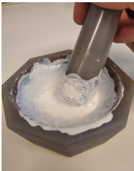
Slika 20. Konzistencija dobivene paste \text{TiO}_2
