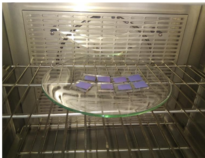
Slika 26. Sušenje stakalaca s apsorbiranim bojilom
