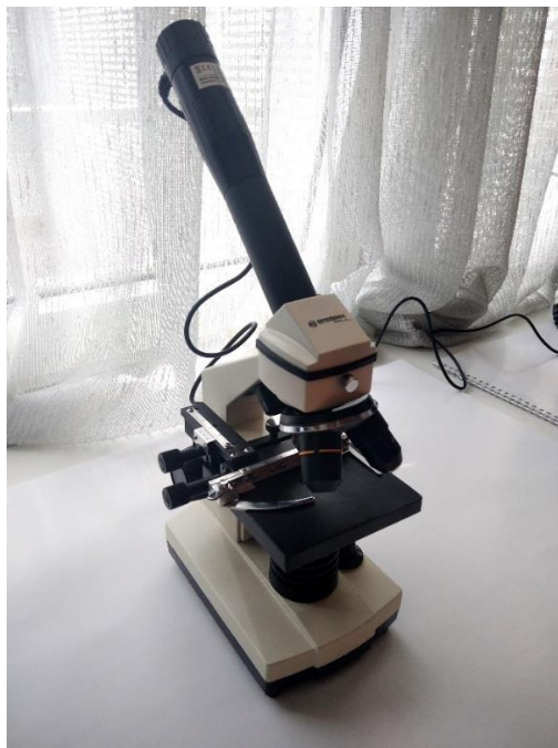
Slika 34. Korišteni mikroskop ( Biolux A1 20x – 1280x)
