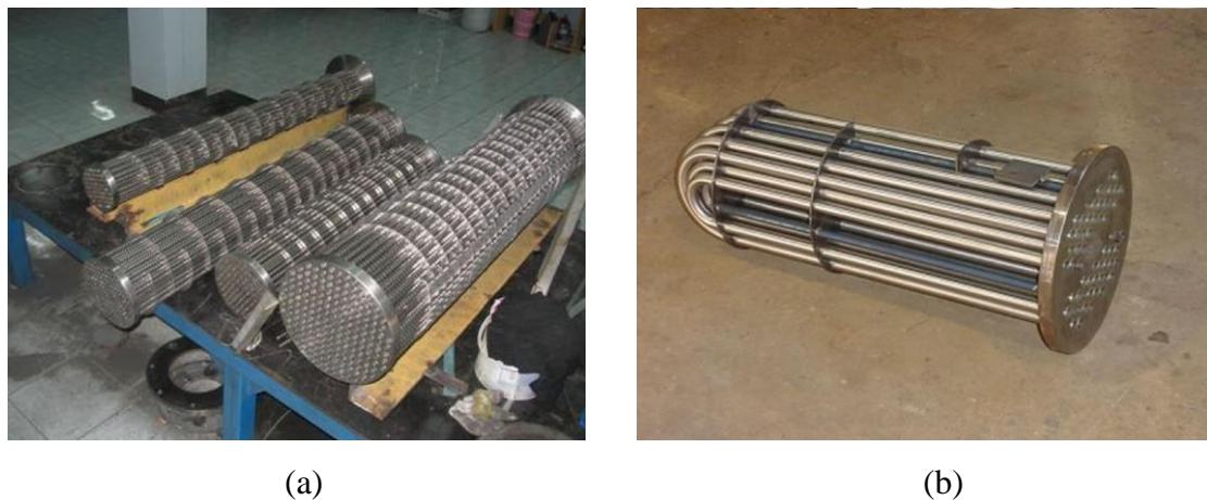
Slika 13. Cijevni snop za izmjenjivač s učvršćenim snopom cijevi (a) i fiksni snop cijevi za U-cijevni izmjenjivač (b)<sup>15</sup>
