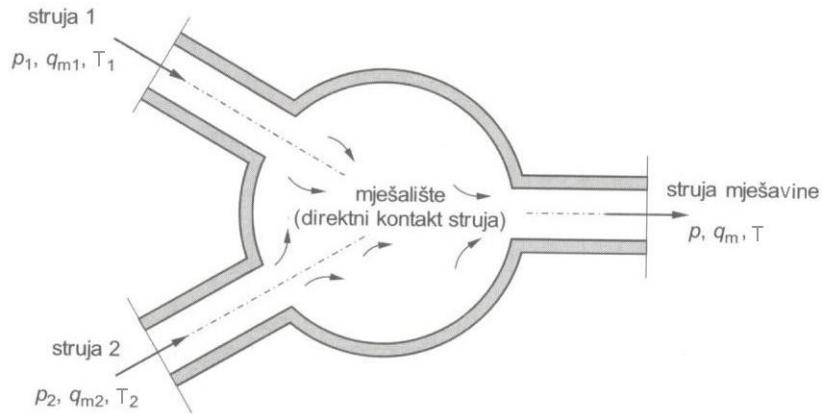
Slika 4. Izravni izmjenjivač topline<sup>6</sup>
