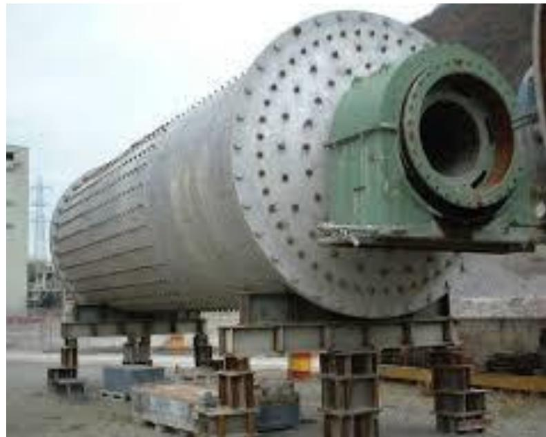
Slika 3. Kuglični mlin za mljevenje sirovinskog materijala na remontu<sup>4</sup>
