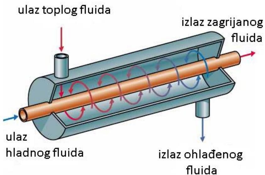
Slika 6. Rekuperativni izmjenjivač topline s jednim prolazom fluida<sup>12</sup>
