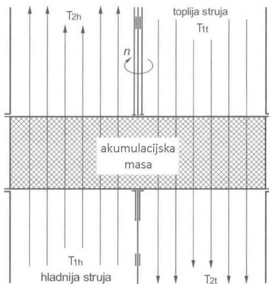
Slika 10. Regenerativni izmjenjivač topline<sup>6</sup>
