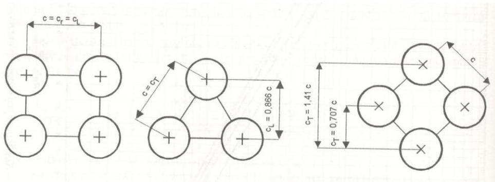
Slika 17. Raspored i korak cijevi u cijevnom snopu<sup>7</sup>
