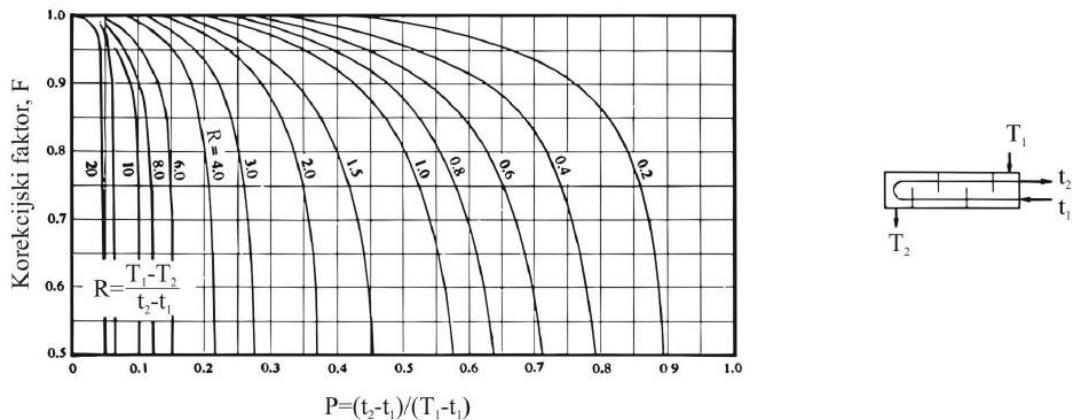
Slika 19. Dijagram<sup>7</sup> ovisnosti F = f(P, R) za protusmjerni izmjenjivač tipa 1-2
