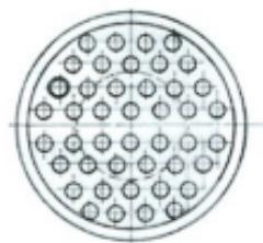
Slika 21. Raspored cijevi u cijevnom snopu 1-2 tipa izmjenjivača
