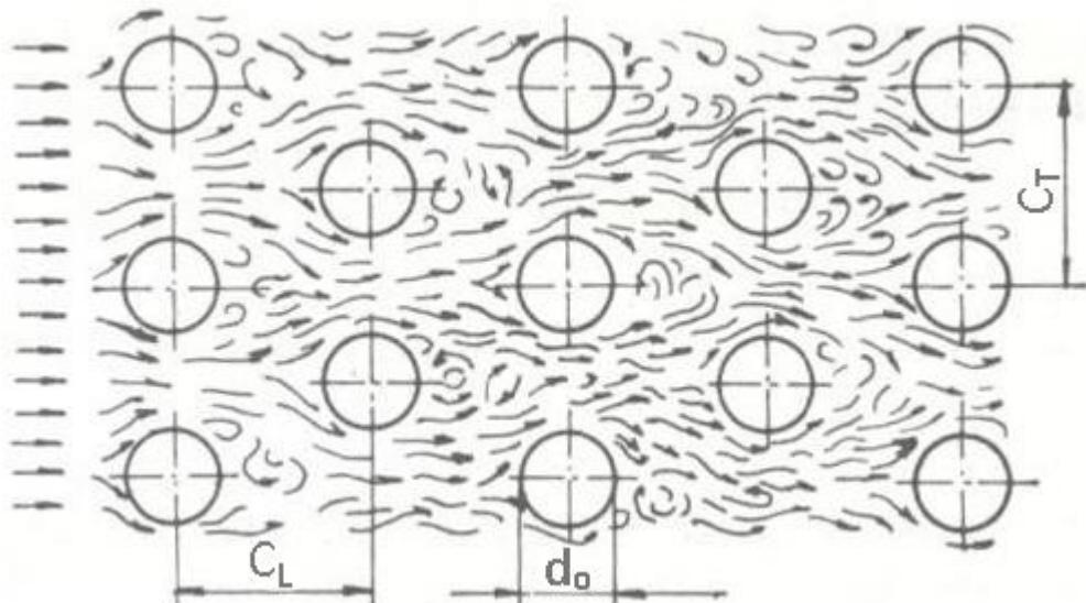
Slika 20. Strujanje fluida preko snopa cijevi u šahovskom rasporedu<sup>8</sup>
