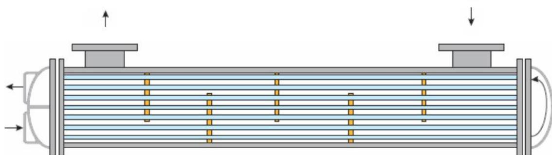
**Slika 11.** Rekuperativni izmjenjivač topline s dva prolaza fluida kroz cijevi i jednim prolazom fluida kroz plašt<sup>13</sup>
