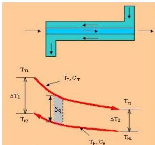
Slika 8. Šematski prikaz protusmjernog izmjenjivača topline i temperaturni pad duž izmjenjivača<sup>12</sup>
