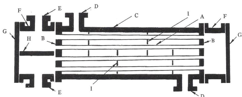
Slika 16. Šematski prikaz izmjenjivača topline s osnovnim dijelovima<sup>10</sup>
