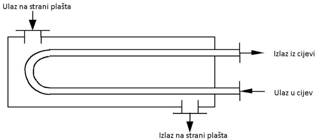
Slika 12. Šematski prikaz 1-2 izmjenjivača topline<sup>14</sup>
