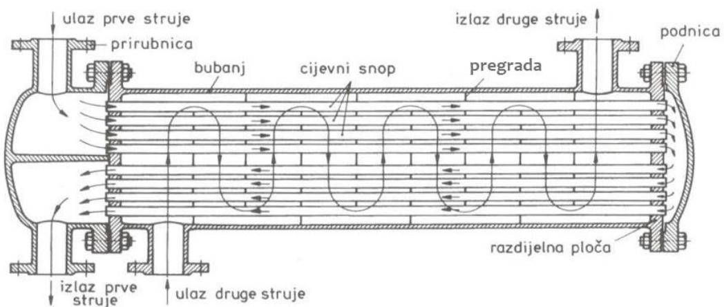
Slika 15. Shematski prikaz proticanja fluida kroz 1-2 izmjenjivač topline<sup>6</sup>
