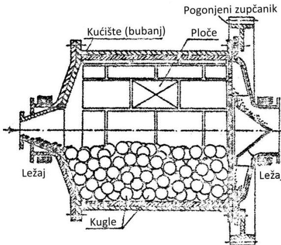
Slika 1. Shematski prikaz kugličnog mlina<sup>2</sup>
