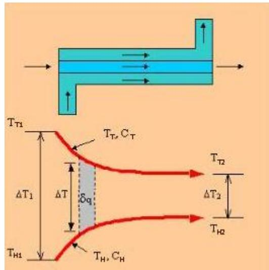
Slika 7. Šematski prikaz istosmjernog izmjenjivača topline i temperaturni pad duž izmjenjivača<sup>12</sup>
