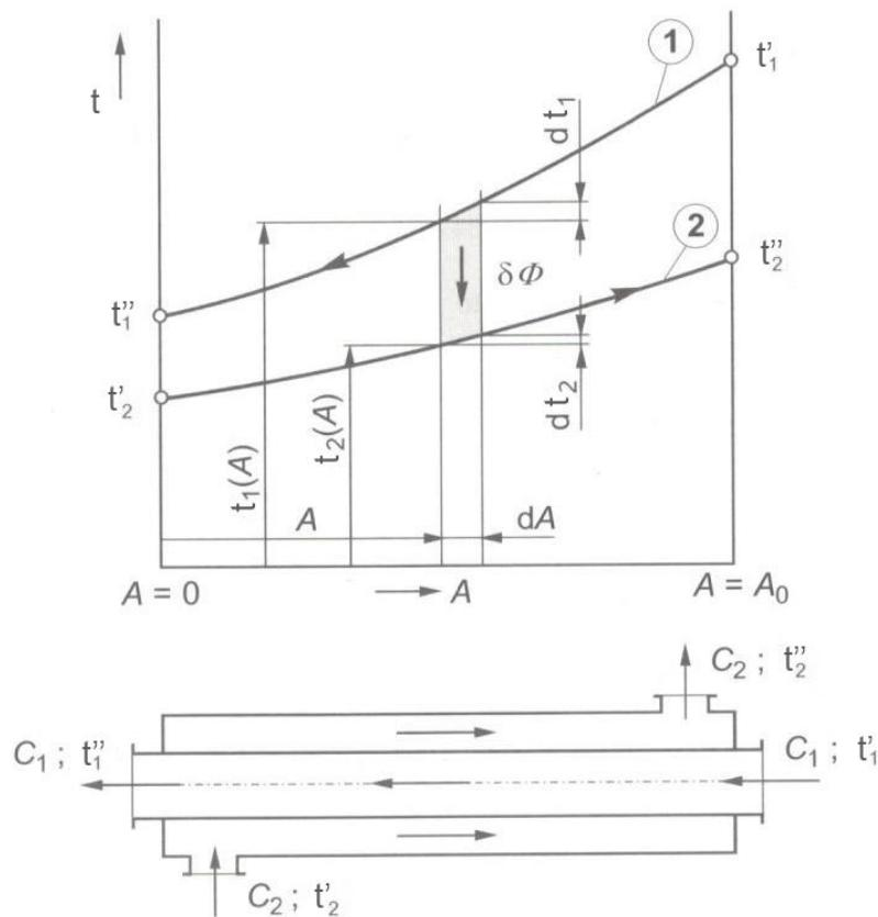
Slika 18. Temperaturni tok struja uzduž protusmjernog izmjenjivača<sup>6,9</sup>
