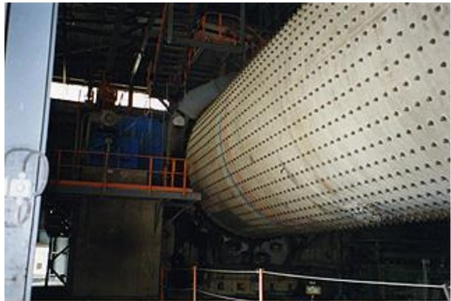
Slika 2. Kuglični mlin za mljevenje sirovinskog materijala<sup>3</sup>
