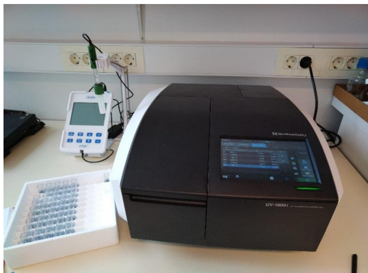
Slika 20. Uzorci ispitivanih cvjetova za određivanje ukupnih fenola i UV/Vis spektrofotometar UV-1900i (Shimadzu) (autorska slika)
