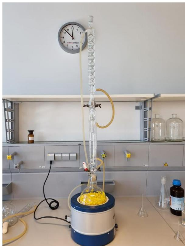
Slika 18. Aparatura za vodenu destilaciju po Clevengeru (modificirana)
