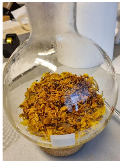
Slika 24. Biljni materijal nakon završetka mikrovalne ekstrakcije bez otapala (spaljen)
