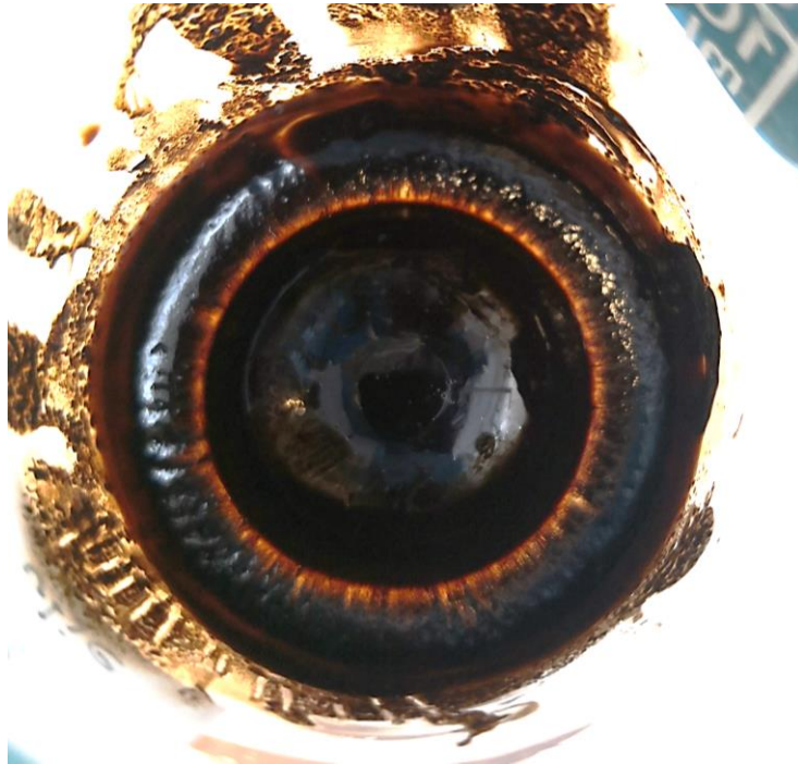
Slika 28. Ferrofluid pripravljen miješanjem motornog ulja s čvrstim nanomagnetitom
