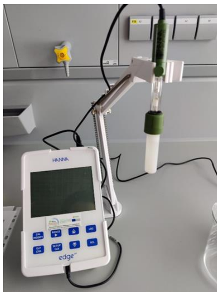
Slika 3. pH-metar korišten za mjerenje pH vrijednosti bujona prije i nakon inkubacije L. paraplantarum (vlastita fotografija)
