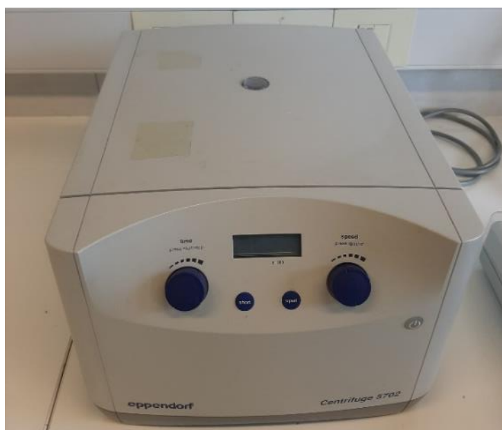
Slika 2. Centrifuga korištena za izdvajanje uzgojnog medija (supernatanta) od bakterijskih stanica L. paraplantaruma taloga (vlastita fotografija)
