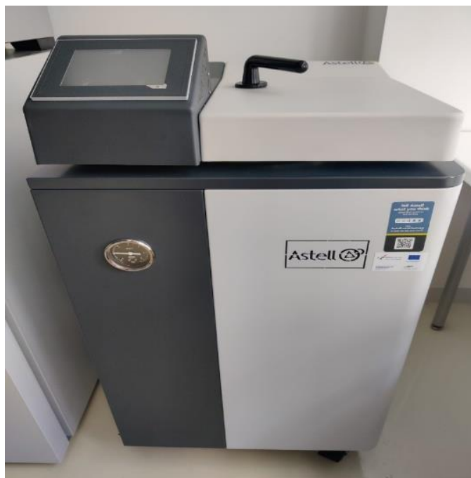
Slika 5. Autoklav korišten u sterilizaciji hranjivih podloga (vlastita fotografija)
