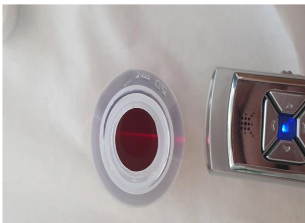
Slika 16. Tyndallov efekt za otopinu pH = 9
