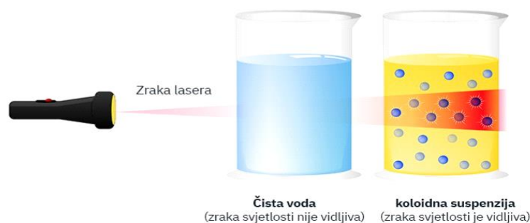
Slika 3. Tyndallov efekt za pravu otopinu i koloidni sustav 11
