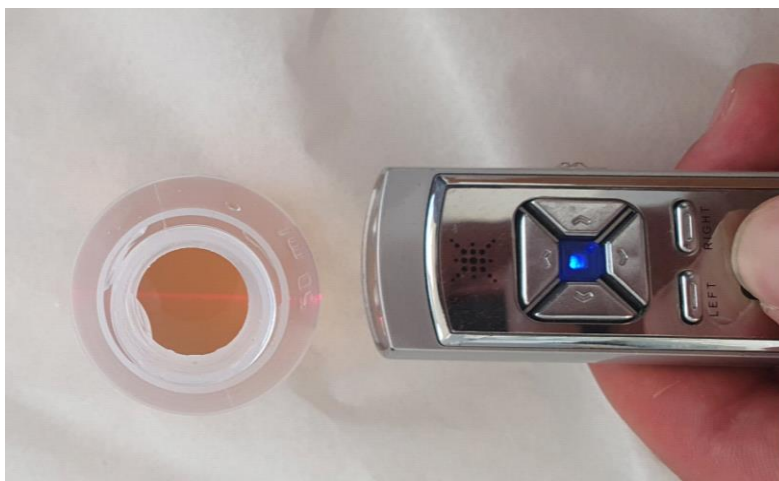
Slika 14. Tyndallov efekt za otopinu pH = 7
