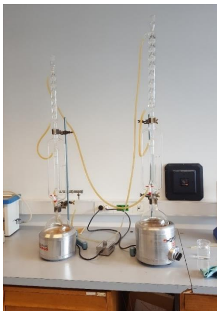
Slika 2.13. Hidrodestilacija L. meyenii .
