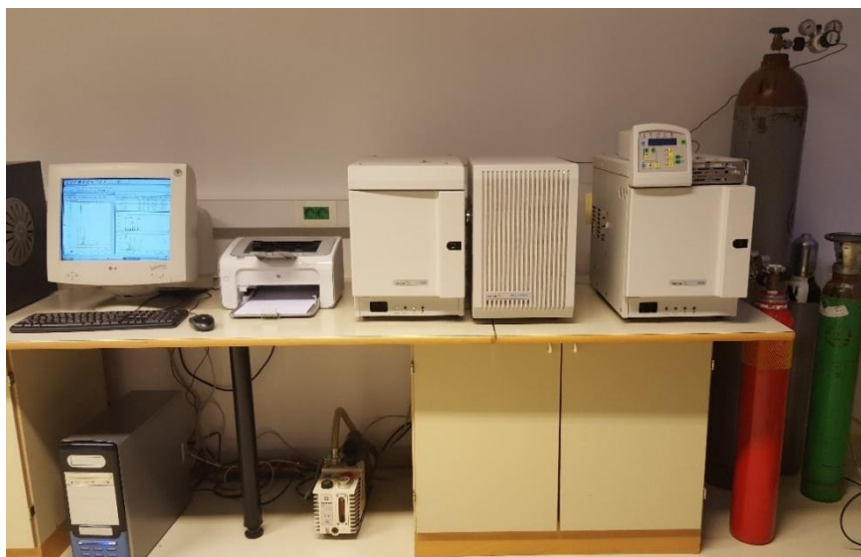
Slika 2.19. Vezani sustav plinska kromatografija- spektrometar masa (GC-MS) korišten za identifikaciju hlapljivih spojeva.
