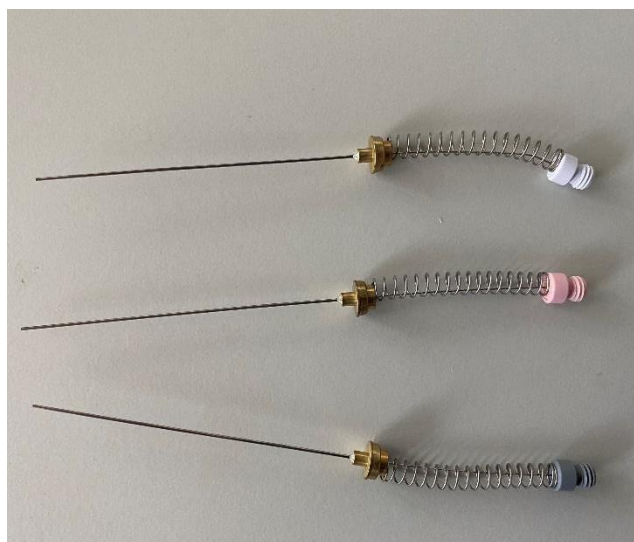
Slika 5. Vlakna različite polarnosti.
