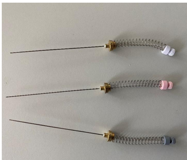
Slika 5. Vlakna različite polarnosti.
