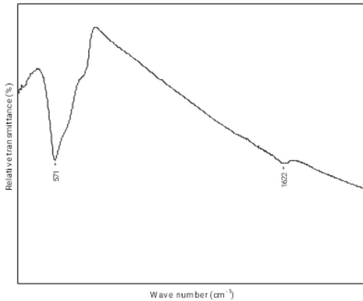
Slika 12. FTIR magnetita
