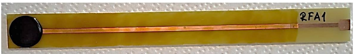
Slika 21. Elektroda spremna za mjerjenje
