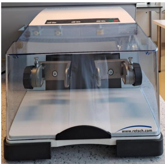
Slika 19. Mlin homogenizator
