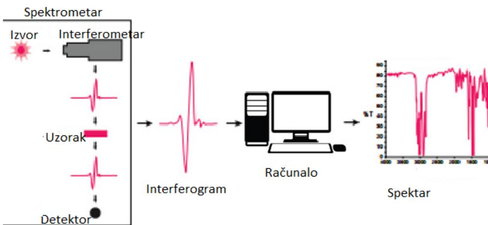
Slika 6. Prikaz mehanizma FTIR analize [30]
