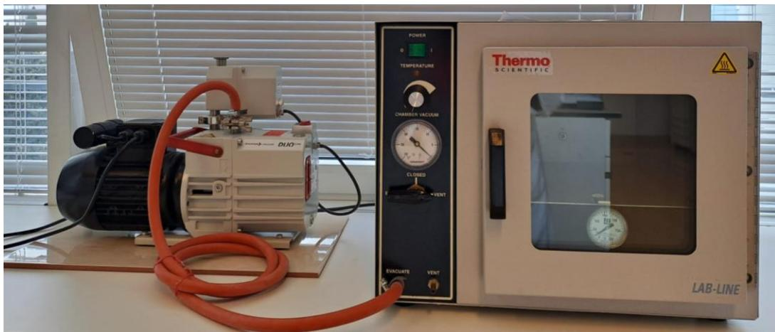
Slika 9. Prikaz vakuum sušionika
