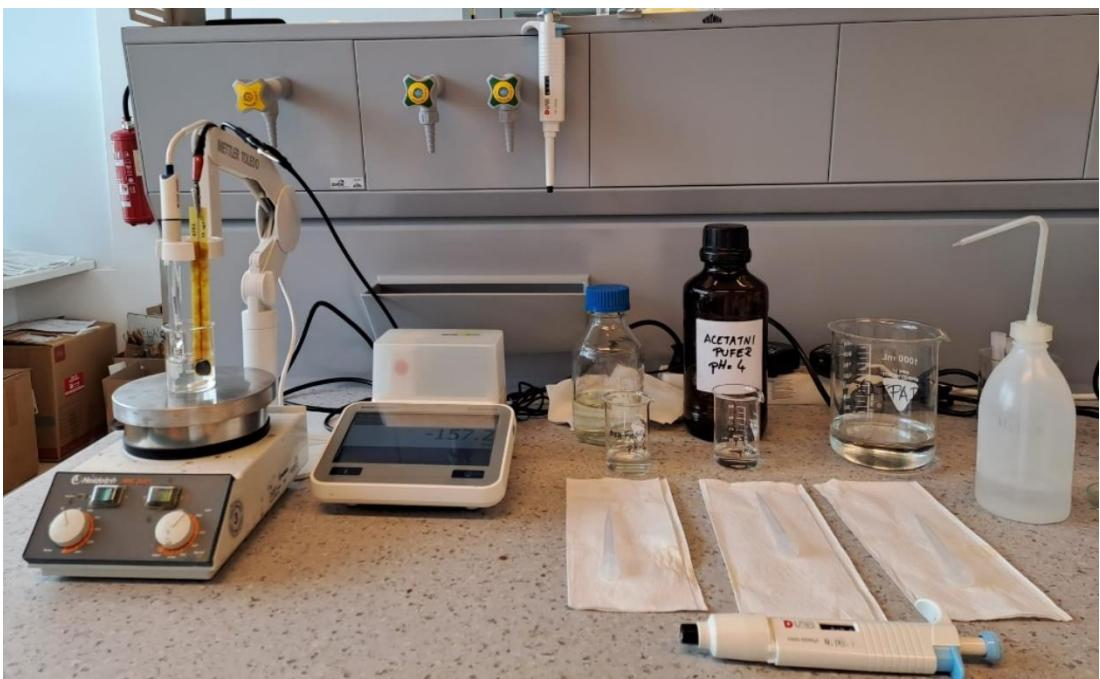
Slika 22. Aparatura korištena za potenciometrijska mjerena
