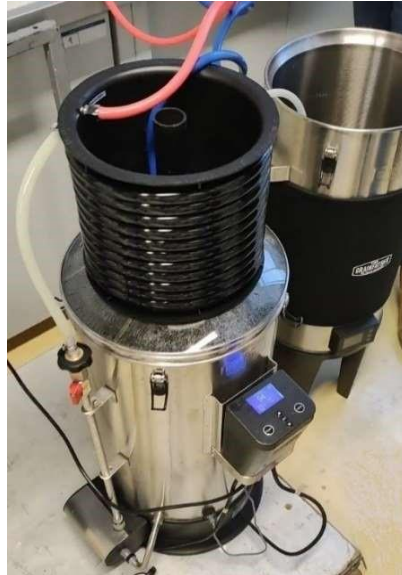
Slika 10. Postupak hlađenja sladovine pomoću spiralnog vodenog hladila
