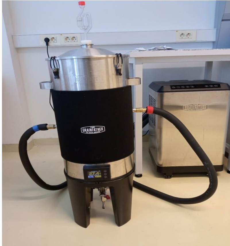
Slika 11. Korišten sustav Grainfather GF30 i GC4 za fermentaciju sladovine
