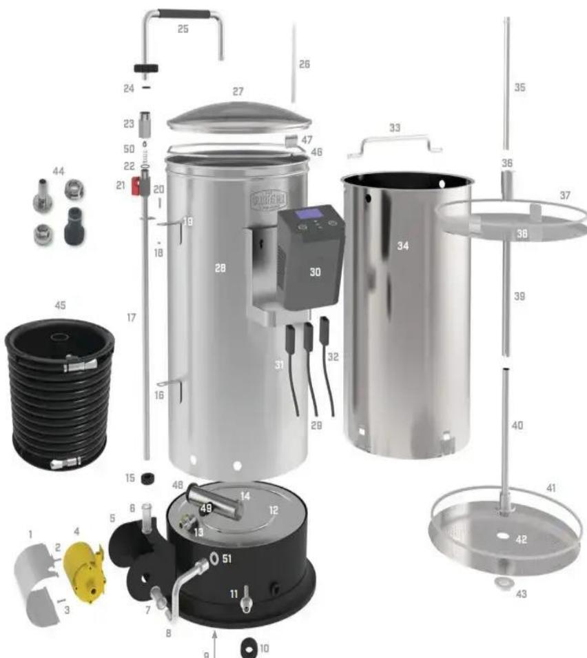
Slika 5. Dijelovi Grainfather G30 uređaja<sup>56</sup>
