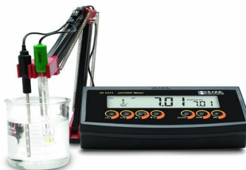
Slika 17. Određivanje pH vrijednosti pomoću digitalnog pH-metra
