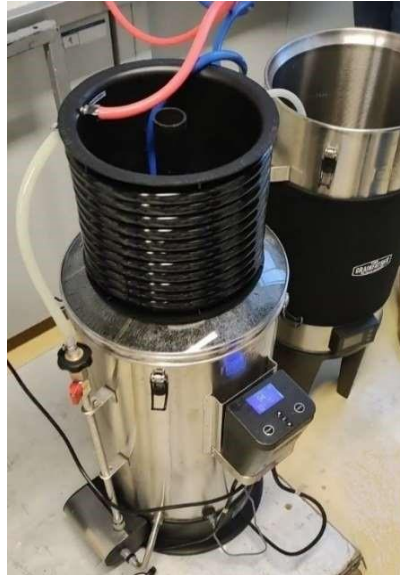
Slika 10. Postupak hlađenja sladovine pomoću spiralnog vodenog hladila
