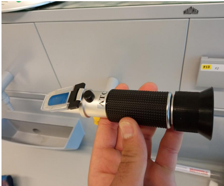
Slika 13. Određivanje sadržaja šećera refraktometrom
