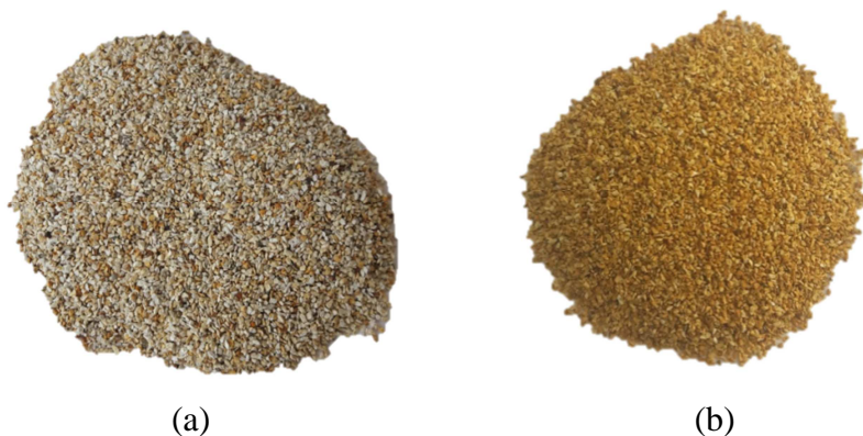
Slika 2.1. Usporedba (a) prirodnog i (b) Fe(III)-modificiranog zeolita.
