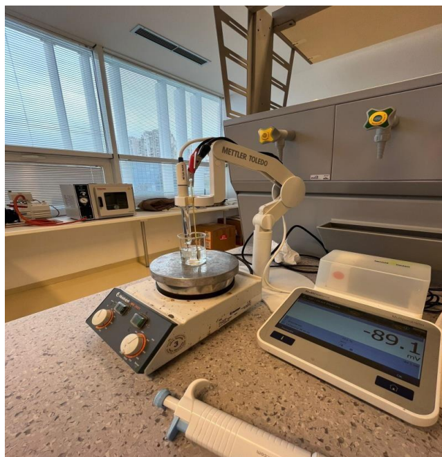
Slika 12. Prikaz potenciometrijskog mjernja
