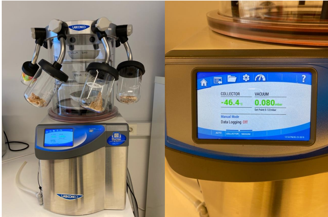
Slika 14. Liofilizacija uzoraka bijele gorušice i daikona
