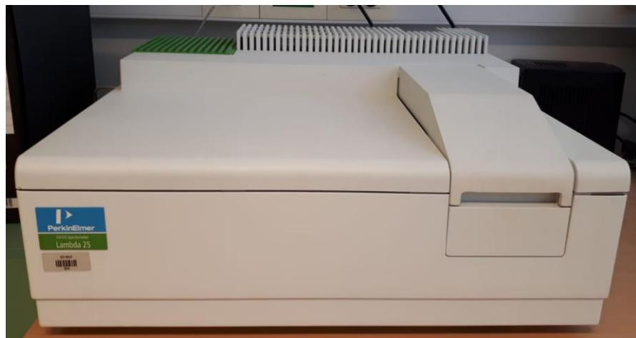
*Slika 10. UV-VIS Spektrofotometar Perkin Elmer 25 Lambda*
