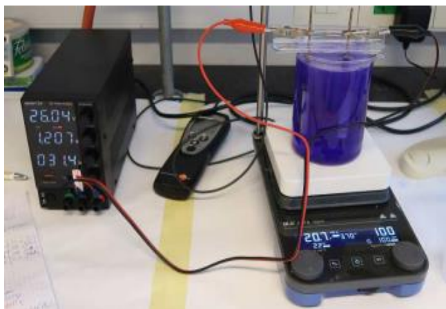
Slika 8. Aparatura za provedbu elektrokoagulacije
