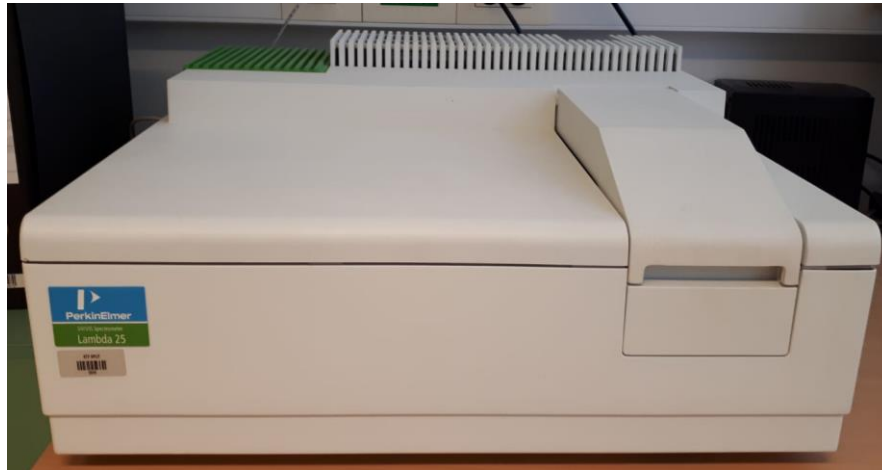
Slika 10. UV-VIS Spektrofotometar Perkin Elmer 25 Lambda
