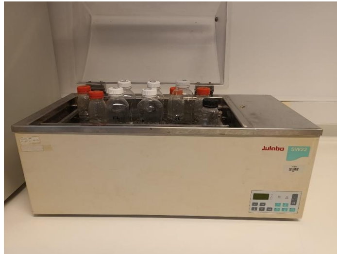
Slika 9. Uređaj za trešnju s vodenom kupelji JULABO SW22
