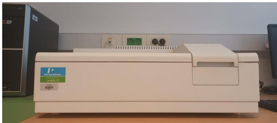
Slika 10. uV/Vis spektrofotometar *PERKIN ELMER LAMBDA 25*
