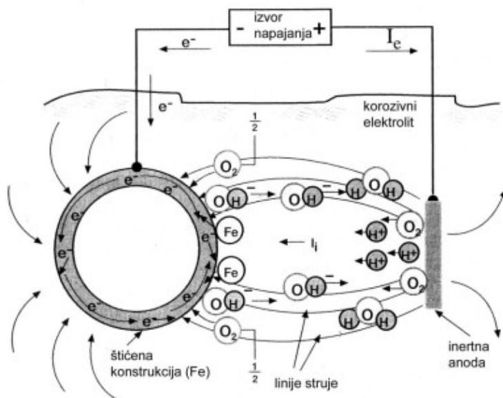
Slika1.1. Katodna zaštita s vanjskim izvorom struje.<sup>9</sup>
