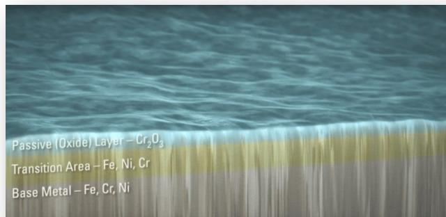
**Slika 1.7.** Mikroskopski film pasivacije na nehrđajućem čeliku.<sup>3</sup>
