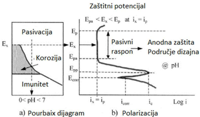
**Slika 1.3.** Shema Pourbaix dijagrama i polarizacijska krivulja metala iz aktivnog do transpasivnog područja pri anodnoj zaštiti.<sup>10</sup>
