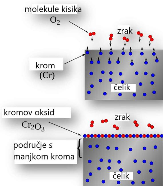
Slika 1.6. Mehanizam pasivacije nehrđajućeg čelika.<sup>5</sup>
