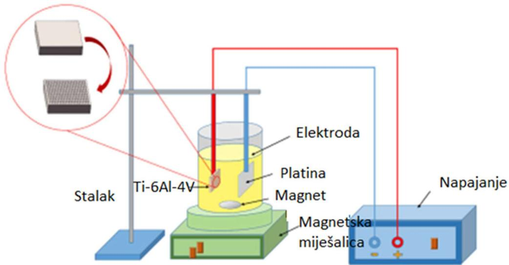
**Slika 1.4.** Shema anodne oksidacije ( $\text{TiO}_2$  na Ti-6Al-4V).<sup>12</sup>
