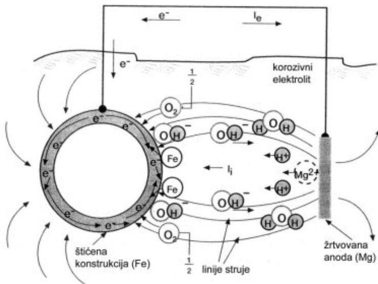
**Slika 1.2.** Katodna zaštita pomoću žrtvovane anode.<sup>9</sup>
