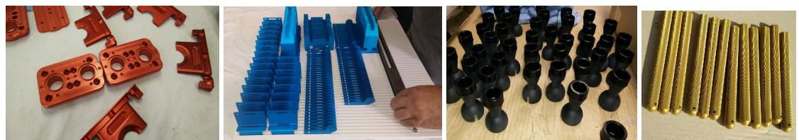
**Slika 1.9.** Primjeri primjene eloksiranog aluminija i legura različitih boja.<sup>44</sup>
