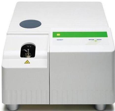
Slika 6. Diferencijalni pretražni kalorimetar Mettler Toledo 823<sup>e</sup>
