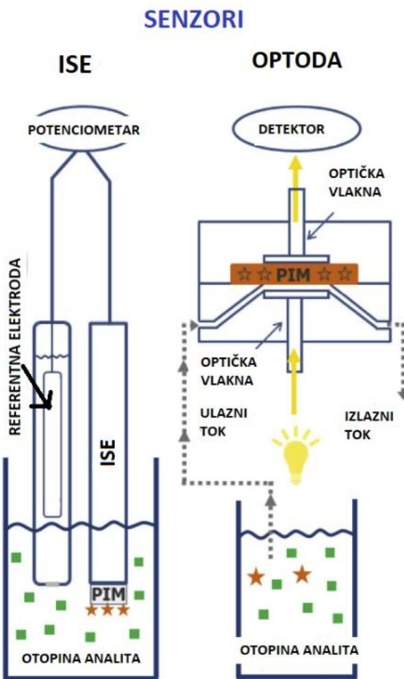
**Slika 8.** Shematski prikaz korištenja PIM u kemijskoj analizi<sup>11</sup>
