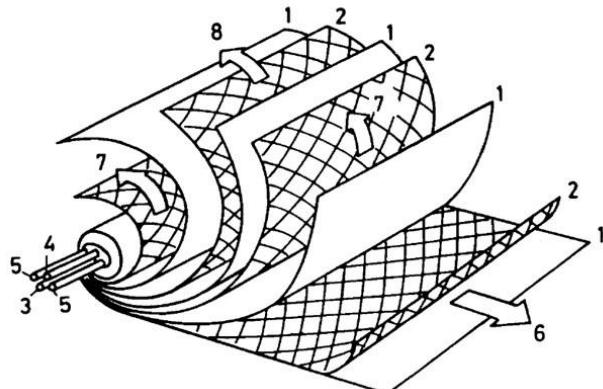
**Slika 7.** Shematski prikaz konfiguracije spiralno namotanog modula kod SLM tekuće membrane<sup>10</sup>
