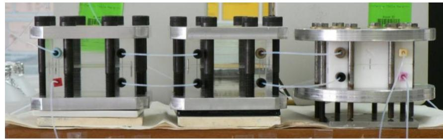
**Slika 6.** Separacijski moduli povezani u seriju pomoću zavojitih kanala između kojih je smještena PIM<sup>9</sup>
