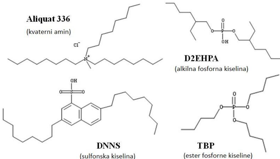
Slika 2. Strukture nekih vrsta nosača<sup>1</sup>
