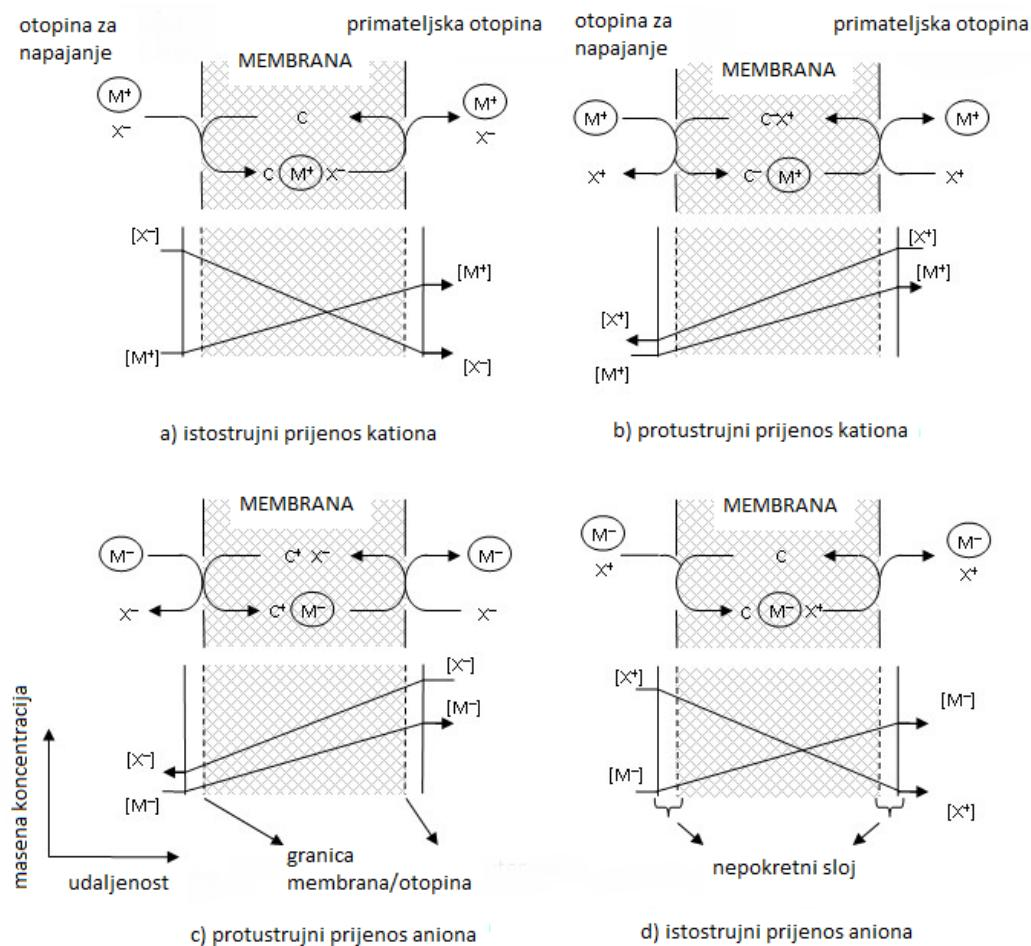
**Slika 4.** Shematski prikaz protustrujnog i istostrujnog prijenosa iona kroz PIM<sup>5</sup>
