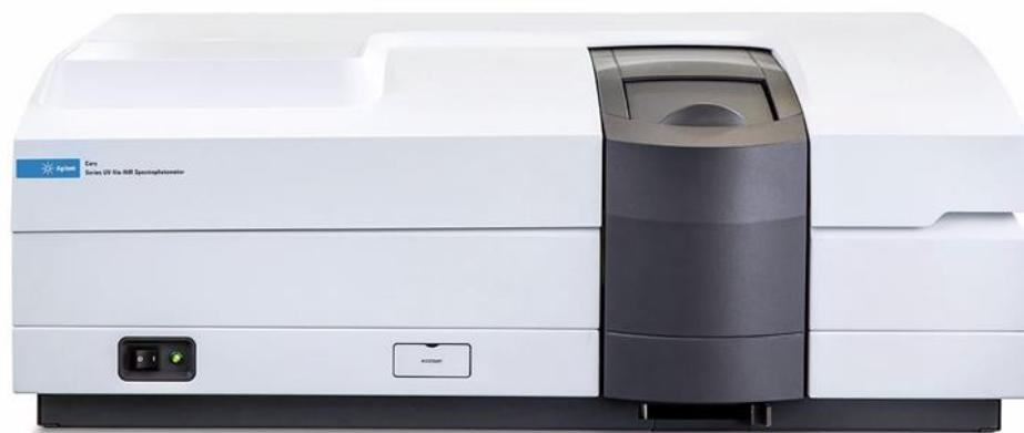
**Slika 11.** Cary 5000 UV-Vis-NIR spektrofotometar.
