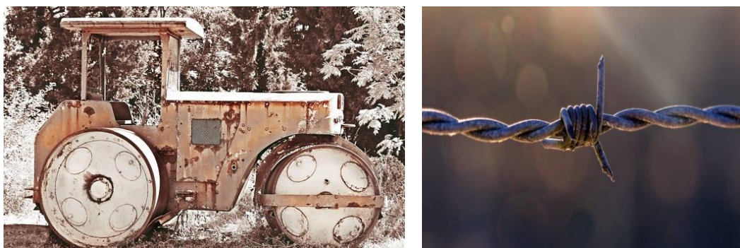
Slika 3. Stari traktor napravljen od čelika ili bodljikava žica od metala koji su dugotrajno izloženi atmosferskim uvjetima poput kiše, snijega i vlage korodiraju. 5,6
