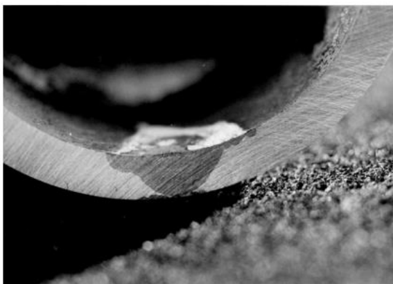
Slika 17. Primjer selektivne korozije. 1
