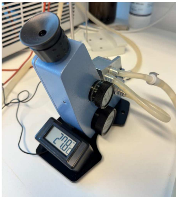
Slika 10. Refraktometar korišten pri provedbi eksperimenta.
