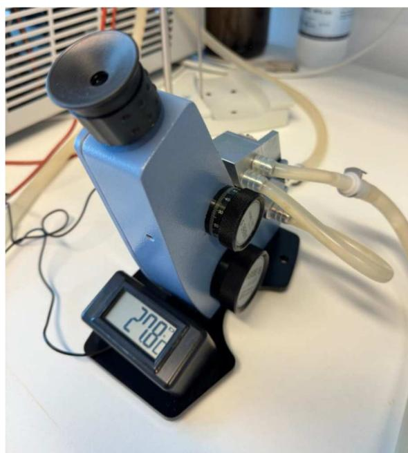
**Slika 10.** Refraktometar korišten pri provedbi eksperimenta.
