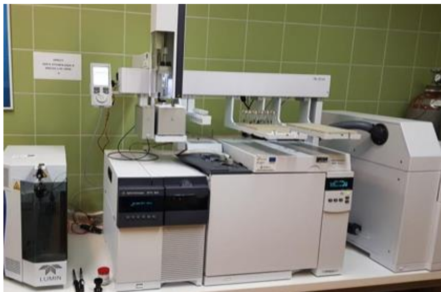
Slika 9. Vezani sustav plinska kromatografija-spektrometrija masa 18
