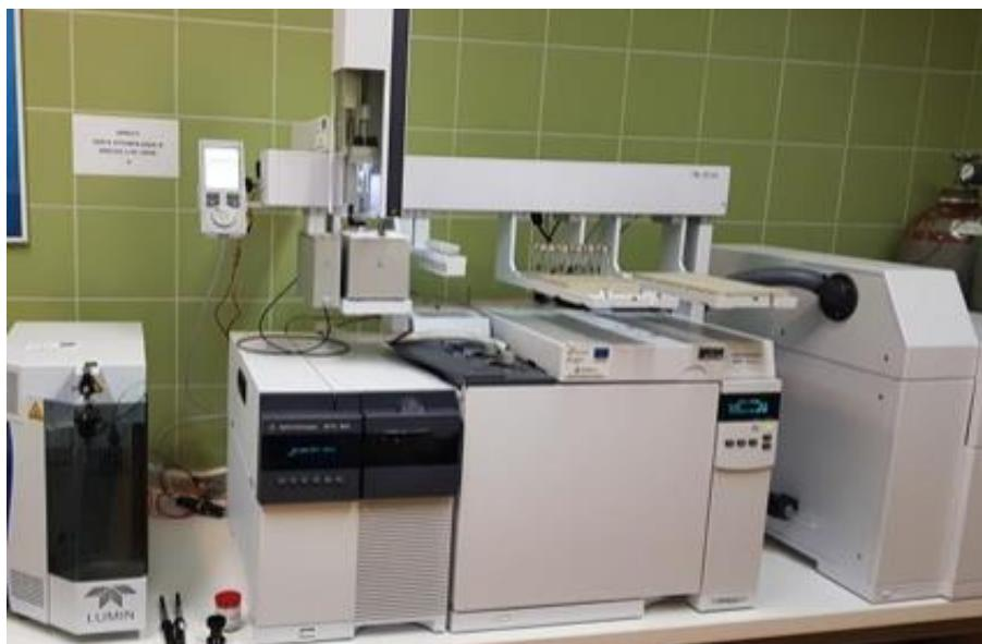
**Slika 9.** Vezani sustav plinska kromatografija-spektrometrija masa<sup>18</sup>
