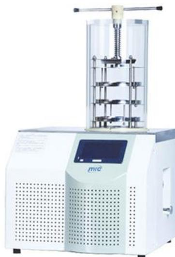
**Slika 5.** Liofilizator<sup>44</sup>
