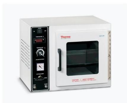
**Slika 9.** Uređaj za vakuum sušenje<sup>57</sup>
