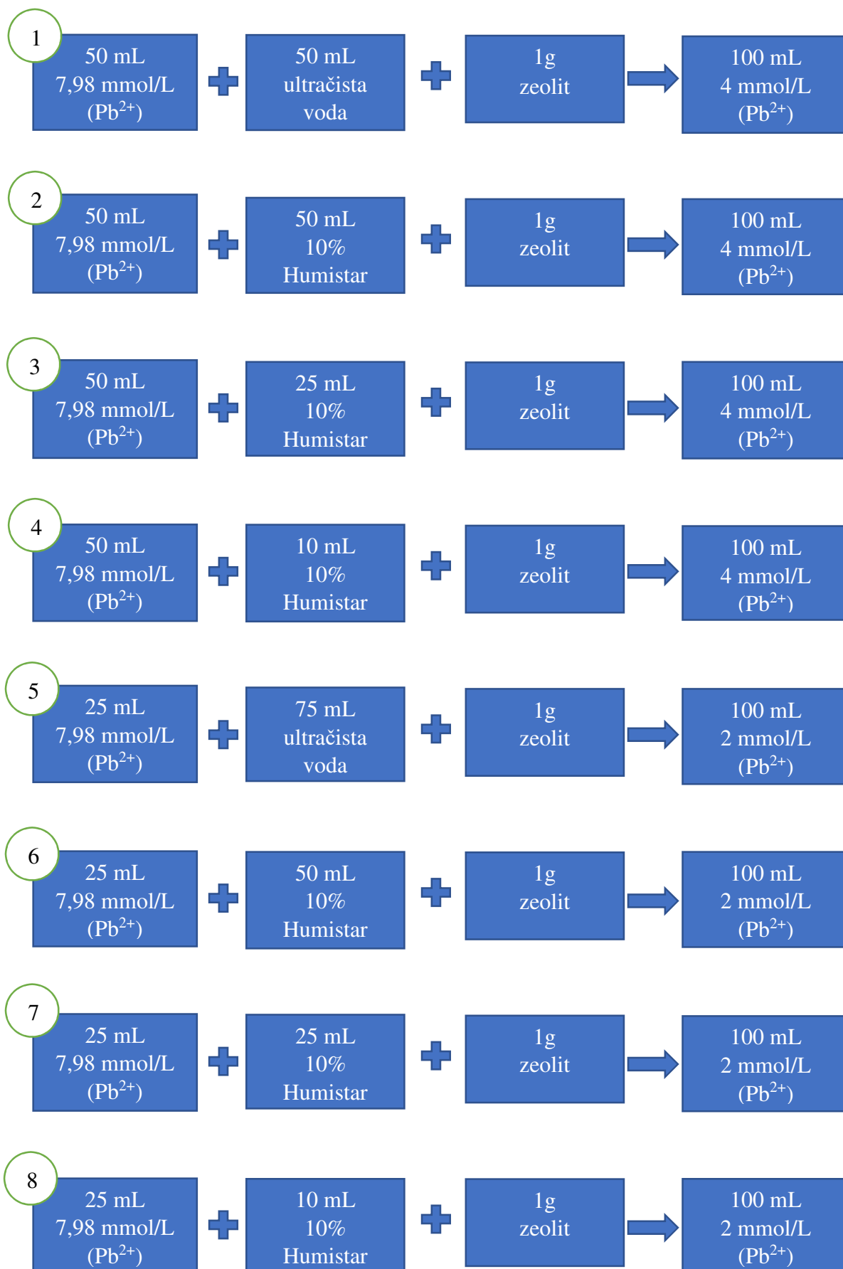
Slika 2.8. Shema eksperimenta vezanja iona olova na zeolitu uz različite dodatke otopine Humistar®.
