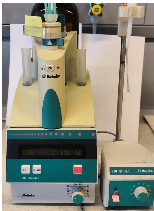
Slika 2.1. Automatski titrator „Metrohm 7775 Dosimat“.
