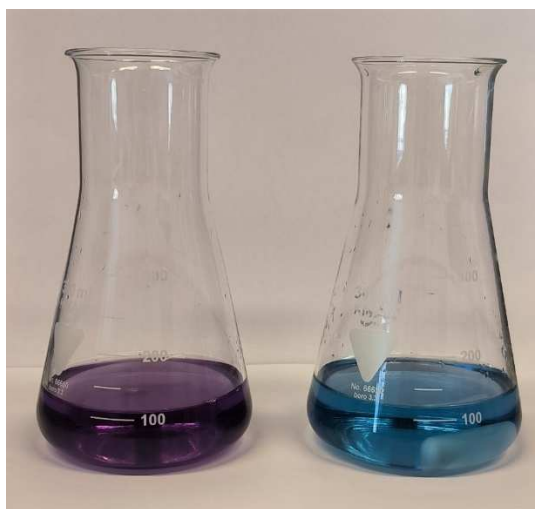
Slika 2.3. Prikaz prijelaza boje pri određivanju koncentracije cinka kompleksometrijskom titracijom.
