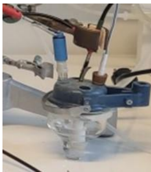
Slika 19. Troelektrodna ćelija za elektrokemijska mjerenja.
