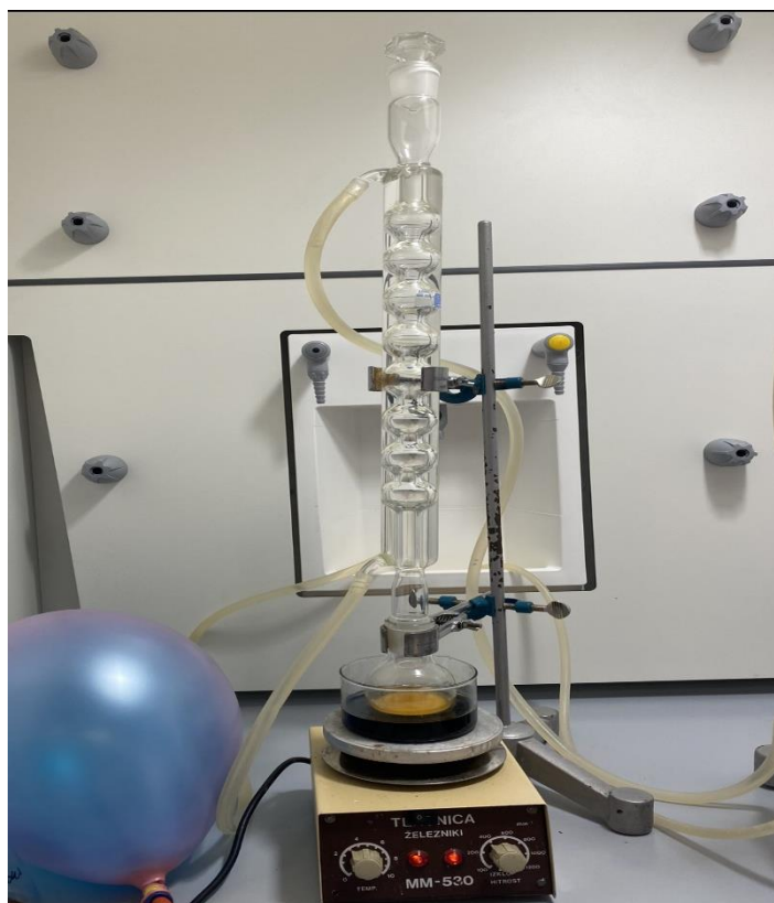
Slika 7. Zagrijavanje u uljnoj kupelji.
