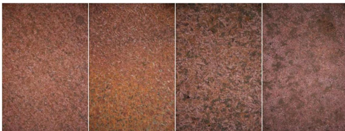
Slika 24. Površina Cu uzorka nakon PD mjerenja u mirujućoj morskoj vodi različitih temperatura: a) T=10^{\circ}\text{C} , b) T=20^{\circ}\text{C} , c) T=30^{\circ}\text{C} , d) T=40^{\circ}\text{C}
