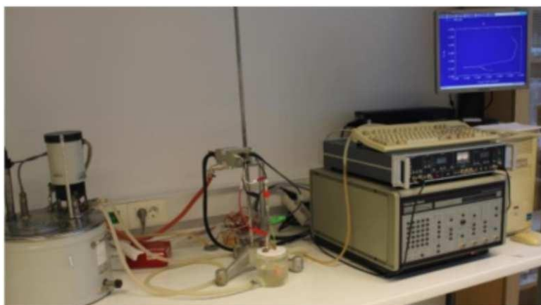
Slika 12. Potencijostat/galvanostat PAR 273A povezan s elektrodama u elektrokemijskoj ćeliji
