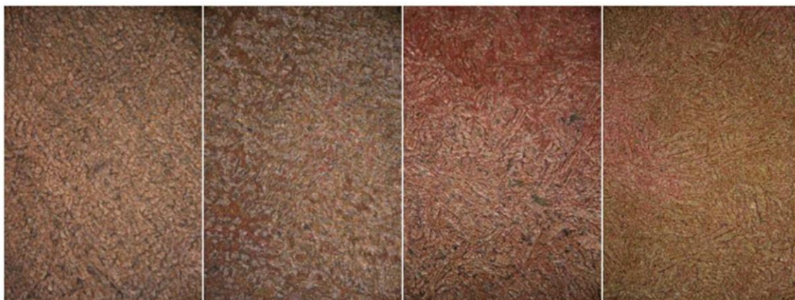
Slika 26. Površina CuAl uzorka nakon PD mjerenja u mirujućoj morskoj vodi različitim temperatura: a) T=10^{\circ}\text{C} , b) T=20^{\circ}\text{C} , c) T=30^{\circ}\text{C} , d) T=40^{\circ}\text{C}
