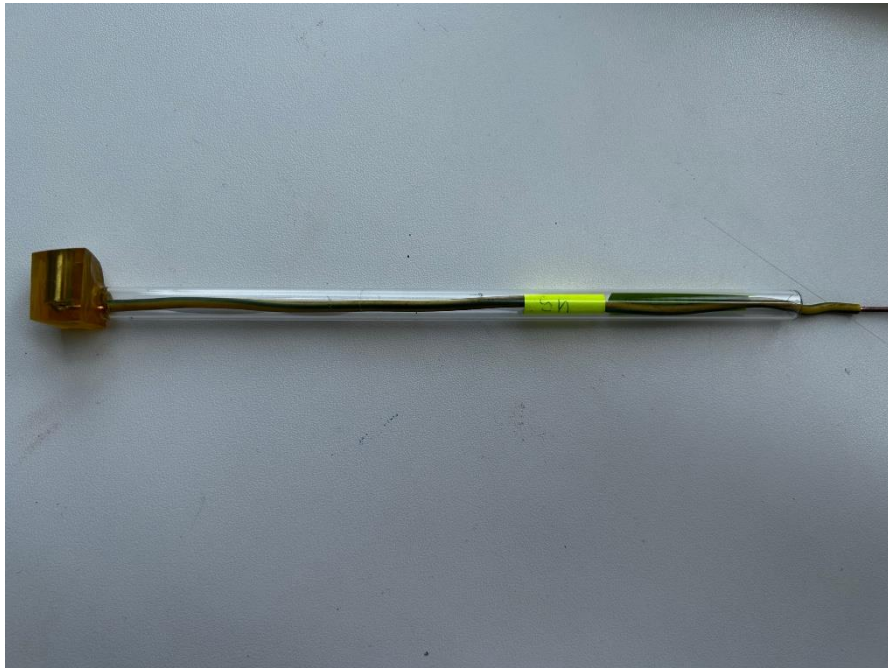
Slika 2.2. Radna elektroda od kositra
