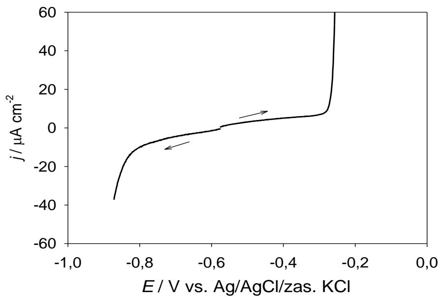
**Slika 3.3.** Katodna i anodna linearna polarizacijska krivulja elektrode Sn u  $0,1 \text{ mol dm}^{-3}$  otopini  $\text{NaCl}$  snimljena brzinom promjene potencijala  $v = 2 \text{ mV s}^{-1}$ . Krivulje su snimljene polazeći od potencijala otvorenog strujnog kruga.
