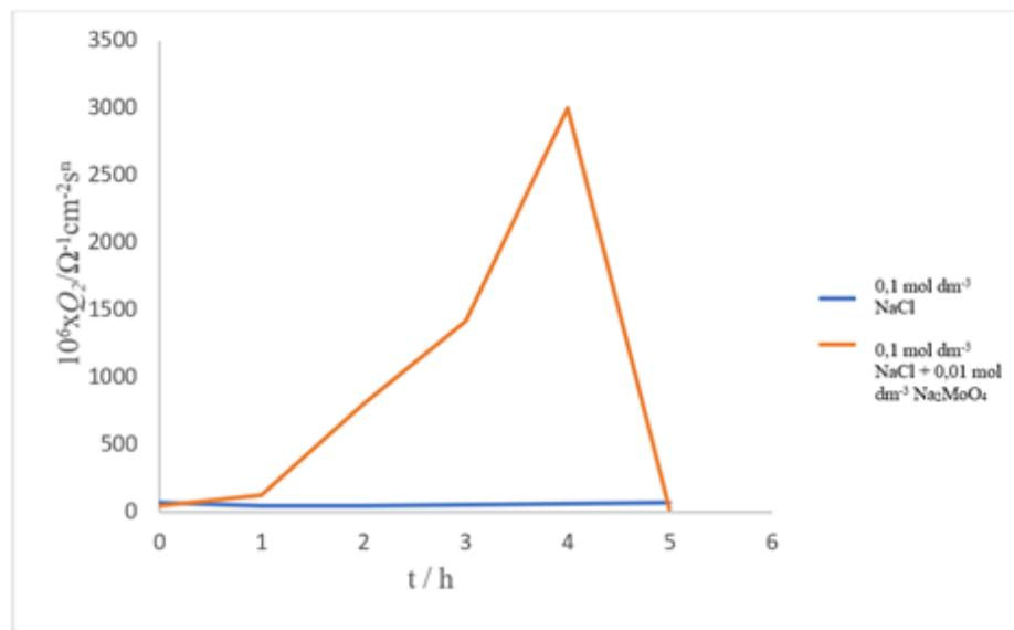
**Slika 4.3.** Ovisnost koeficijenta konstantno faznog elementa  $Q_2$  o vremenu, tijekom boravka Sn elektrode u  $0,1 \text{ mol dm}^{-3}$  otopini  $\text{NaCl}$  i u  $0,01 \text{ mol dm}^{-3}$  otopini  $\text{Na}_2\text{MoO}_4$  u  $0,1 \text{ mol dm}^{-3}$  otopini  $\text{NaCl}$ .
