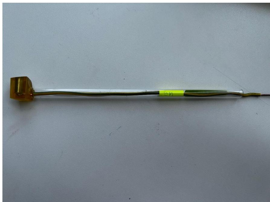
**Slika 2.2.** Radna elektroda od kositra
