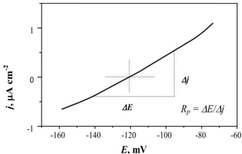
**Slika 1.2.** Određivanje polarizacijskog otpora.<sup>11</sup>
