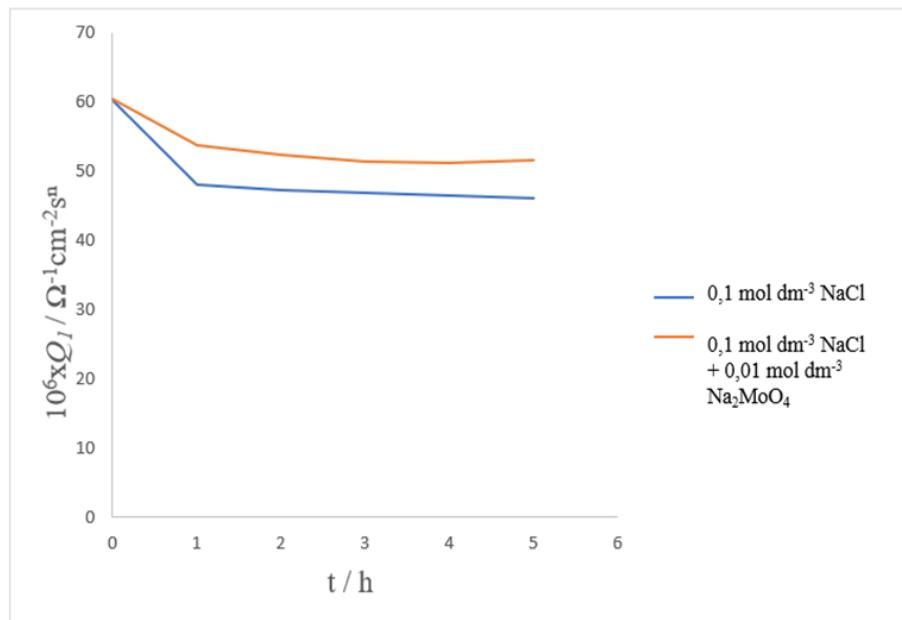
**Slika 4.1.** Ovisnost koeficijenta konstantno faznog elementa  $Q_1$  o vremenu, tijekom boravka Sn elektrode u  $0,1 \text{ mol dm}^{-3}$  otopini NaCl i u  $0,01 \text{ mol dm}^{-3}$  otopini  $\text{Na}_2\text{MoO}_4$  u  $0,1 \text{ mol dm}^{-3}$  otopini NaCl.
