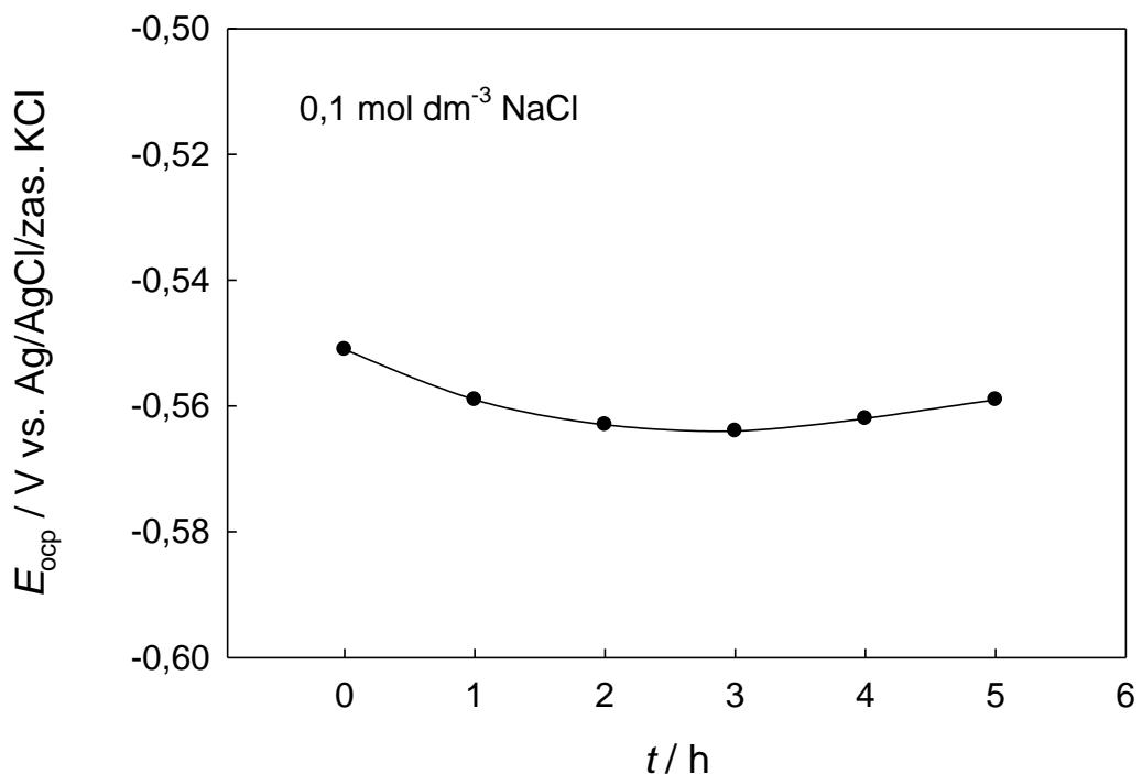
**Slika 3.1.** Ovisnost potencijala otvorenog strujnog kruga  $E_{\text{ocp}}$  elektrode Sn u  $0,1 \text{ mol dm}^{-3}$  otopini NaCl pH 7.
