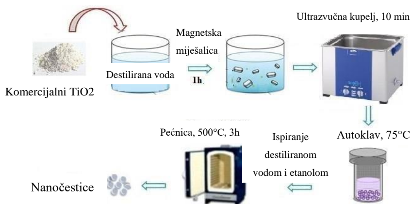
Slika 9. Primjer sinteze nanostrukturiranog \text{TiO}_2 hidrotermalnom metodom 25
