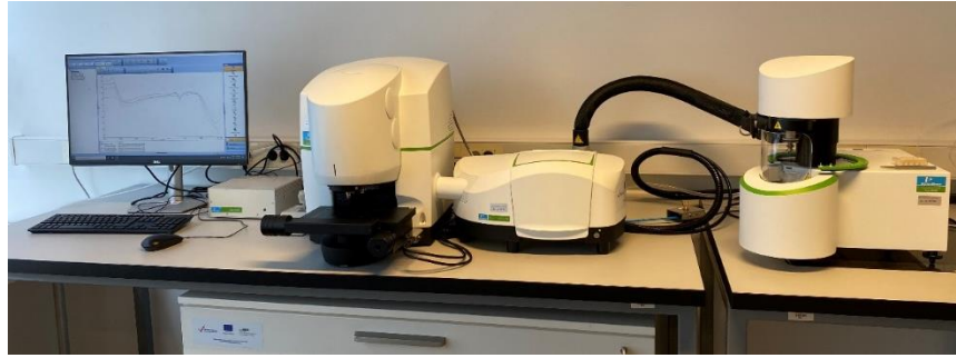
Slika 16. FT-IR spektrometar Spectrum Two, Perkin Elmer
