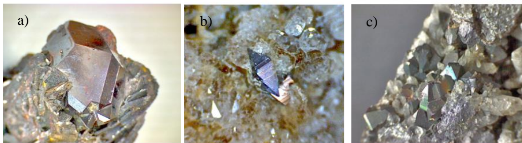
Slika 2. Prikaz titanijevih ruda a) rutil b) anatas c) brukit 1
